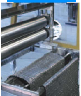
Пропитка покрытия MapeWrap C в машине
