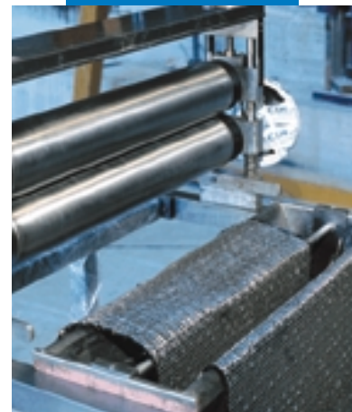
Impregnazione a macchina di Mapewrap C
