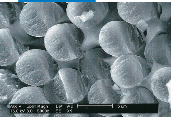
Microfotografia di un composto strutturale a matrice polimerica dal Laboratorio di Ricerca e Sviluppo Mapei
