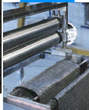
Пропитка покрытия Марепрар C с помощью машины
