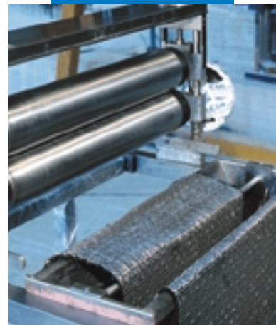
Impregnazione a macchina di Mapewrap C
